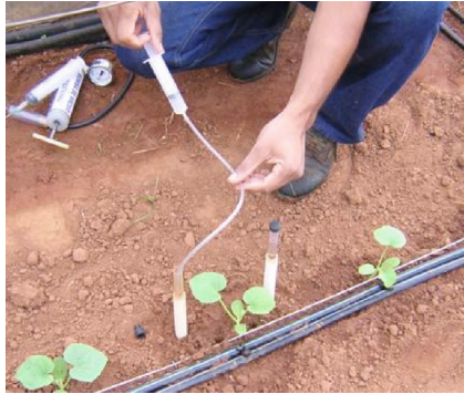
Figura 3 O monitoramento da fertirrigação e o controle de nutrientes em solos com auxílio dos extratores de solução evita a salinização e o desequilíbrio nutricional
