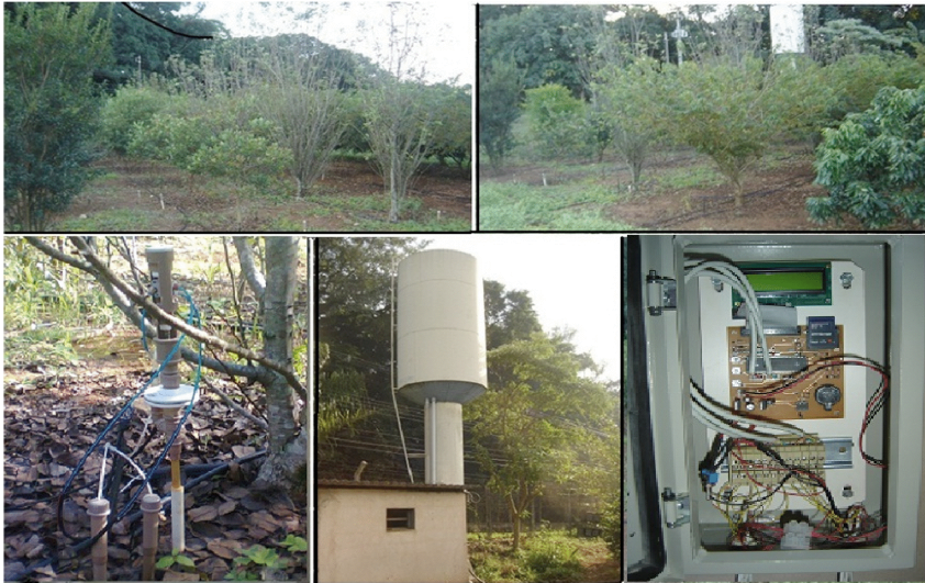
Figura 4 Experimento em campo para avaliação do controlador acionado mecanicamente no controle da irrigação de um pomar de fruteiras, com irrigação pressurizada por gravidade (Foto extraída da tese de doutorado de Almeida (2012))
