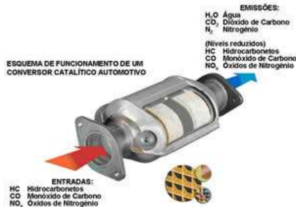
Figura 3 – Representação esquemática de um conversor catalítico automotivo
