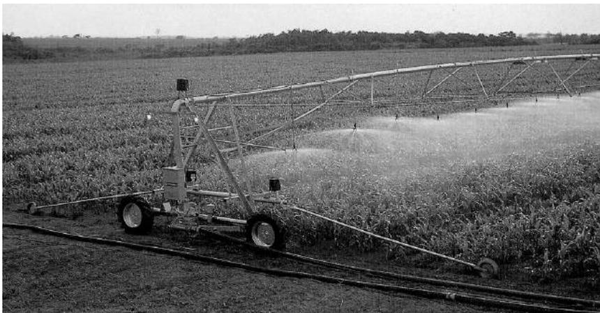
Figura 2.15 - Captação através de mangueira
