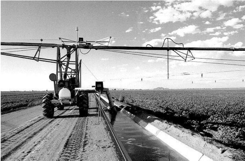
Figura 2.14 - Captação direta de um sistema lateral móvel
