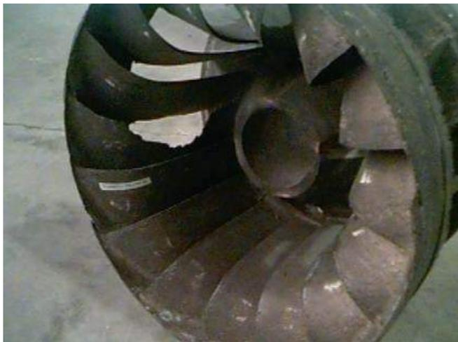
Figura 6.21 - Rotor Francis danificado por ação da cavitação
