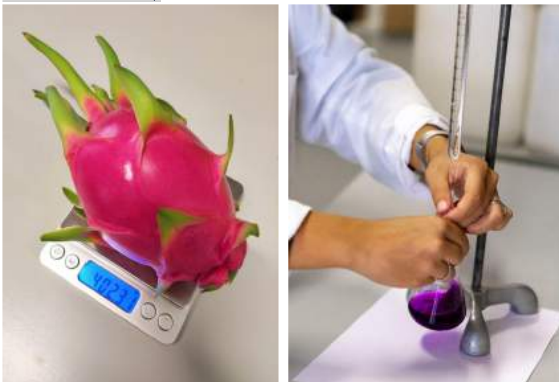
Figura 11. Determinação de parâmetros físicos e químicos dos frutos (peso, à esquerda e acidez titulável, à direita).
