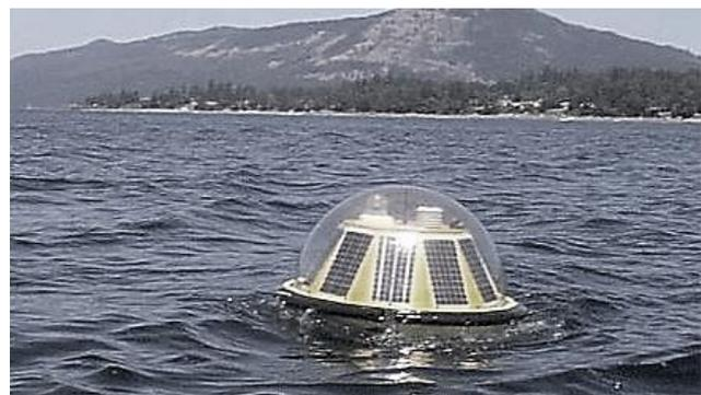
Medição de salinidade, temperatura, pressão, etc.
