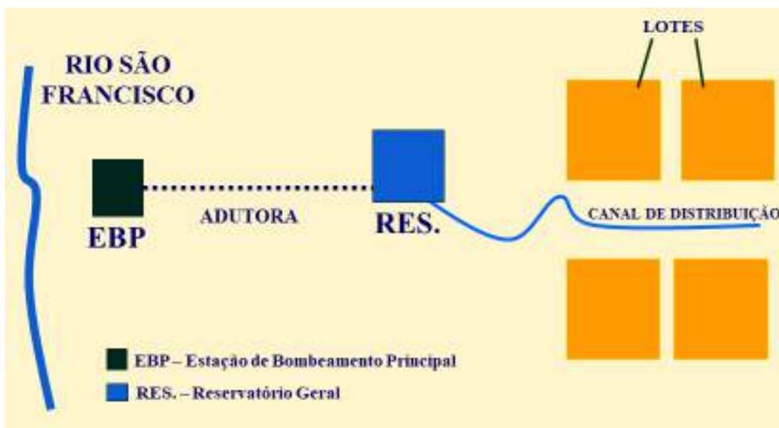
Figura 2. Modelo esquemático de funcionamento do projeto público de irrigação (PPI) Mandacaru antes da conversão dos sistemas.
