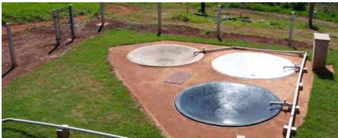
Figura 2. Reator solar de tronco cônico invertido (QUELUZ; SÁNCHEZ ROMÁN; 2014).
