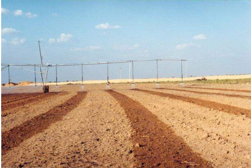
Figura 6. Faixa molhada em pivô central. Aspensor tipo Lepa.
