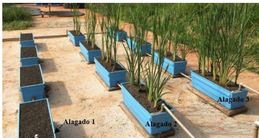
Figura 5. Sistemas de alagados construídos com e sem cultivo de taboa ( Typha latifolia ) (QUELUZ, 2016).
