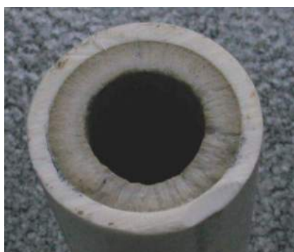
Figura 10. Tubo PVC (1 ½ pol) com um ano de uso parcialmente entupido por cristais de carbonato de cálcio.
