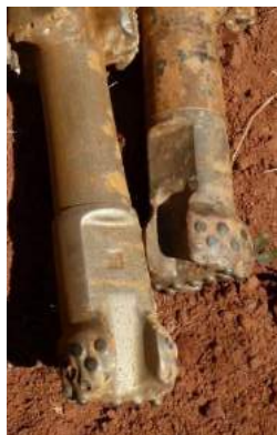
Figura 8. Nódulos endurecidos na extremidade de brocas.
